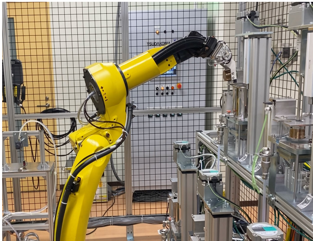
図1 世界初、全自動の植物由来（木材・稲藁・農業廃棄物など）樹脂合成ロボットシステム
